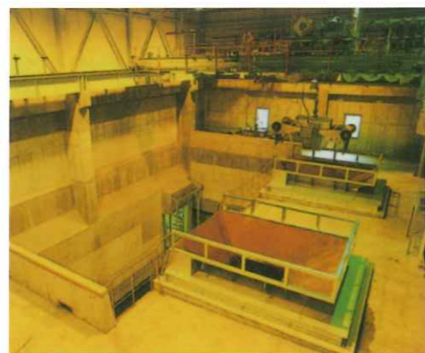
● ごみピット、ごみクレーン ごみピットに貯留されたごみをクレーンでつかんで、投入ホッパへ投入します。
